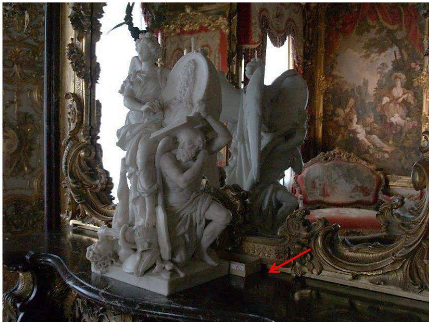
Abbildung 6: Staubmonitoring am Beispiel der losen Staubsammler im Westlichen Gobelinzimmer, © Bayerische Schlösserverwaltung.
