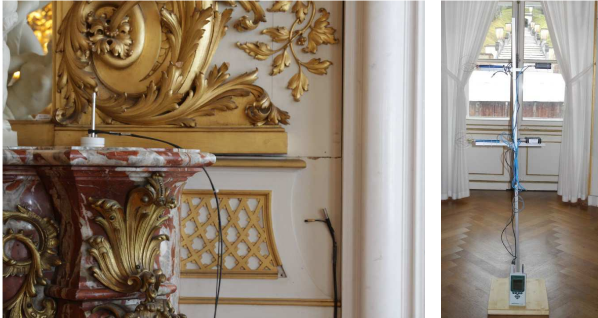
Abbildung 4: Links: Nahfeldklimamessung am Beispiel der Westwand im Paradeschlafzimmer. Rechts: Messbaum mit Sensoren zur Strömungsmessung und die lokale Erfassung des Raumklimas, © Bayerische Schlösserverwaltung.
